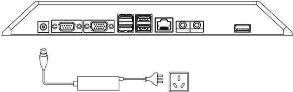
Cabo de energia, periféricos e conexão do cabo de comunicação.
